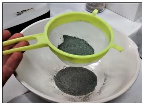
Figura 45. Tamizado de muestra usando coladores de plástico.
