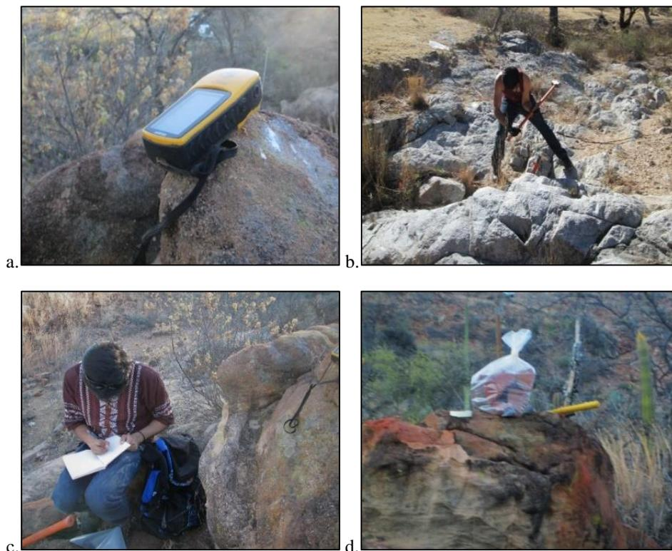
Figura 8. Recolección de muestras. a) GPS Garmin eTrex® H. b) Marro y cincel usados para fragmentar las rocas, c) Descripción macroscópica de muestras d) Muestra fragmentada y empacada en bolsa de nylon.
