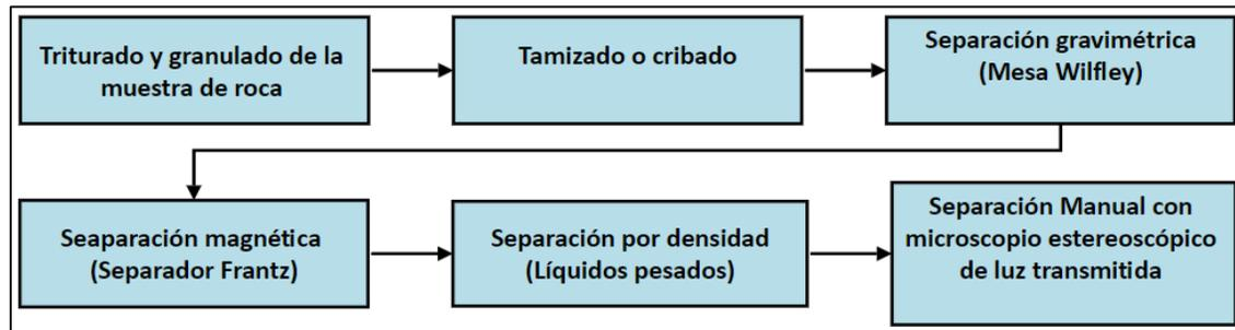
Figura 17. Diagrama de las etapas del método de separación de zircones por mesa Wilfley.
