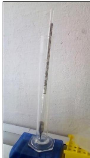
Figura 34. Probeta y densímetro de flotación usado para determinar la densidad de la solución politungstato de sodio.
