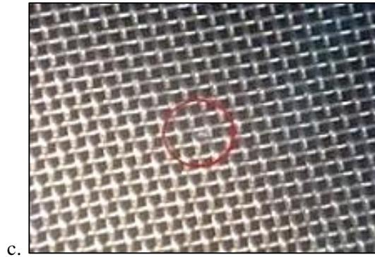
Figura 24. a), b) y c) Vista en microscopio (0.67X) de los tamices (a-50, b-100, c-120) se señalan con un círculo rojo las partículas minerales atascadas en las mallas aún después de ser lavados en baño ultrasónico.
