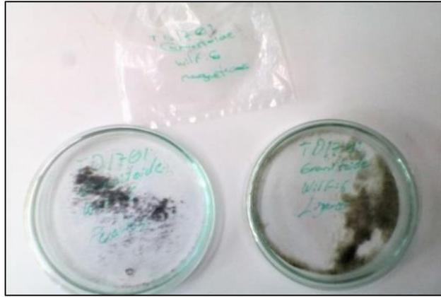
Figura 36. Cajas de petri conteniendo la fracción pesada y ligera de una fracción de la muestra TD1702 (Cuarzo-diorita). La bolsa contiene la fracción magnética.
