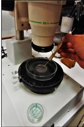
Figura 37. Equipo utilizado en la separación de zircones por Hand Picking usando un microscopio Olympus® SZ11.
