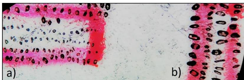
Figura 53. Ejemplo de zirrones de la muestra TD1703 (Arcosa lítica) montados en resina epóxica para datación por el método de U-Pb mediante LA ICP-MS. a) Zirrones obtenidos con el método por decantación. b) Zirrones obtenidos con el método por mesa Wilfley
