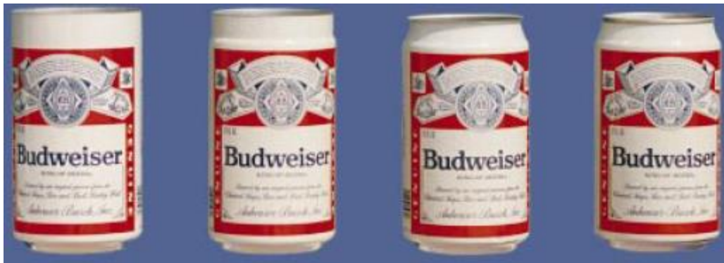
Figura 1.7 – Decoración del cuerpo, formación del cuello y pestaña para agregar la tapa de la lata.
