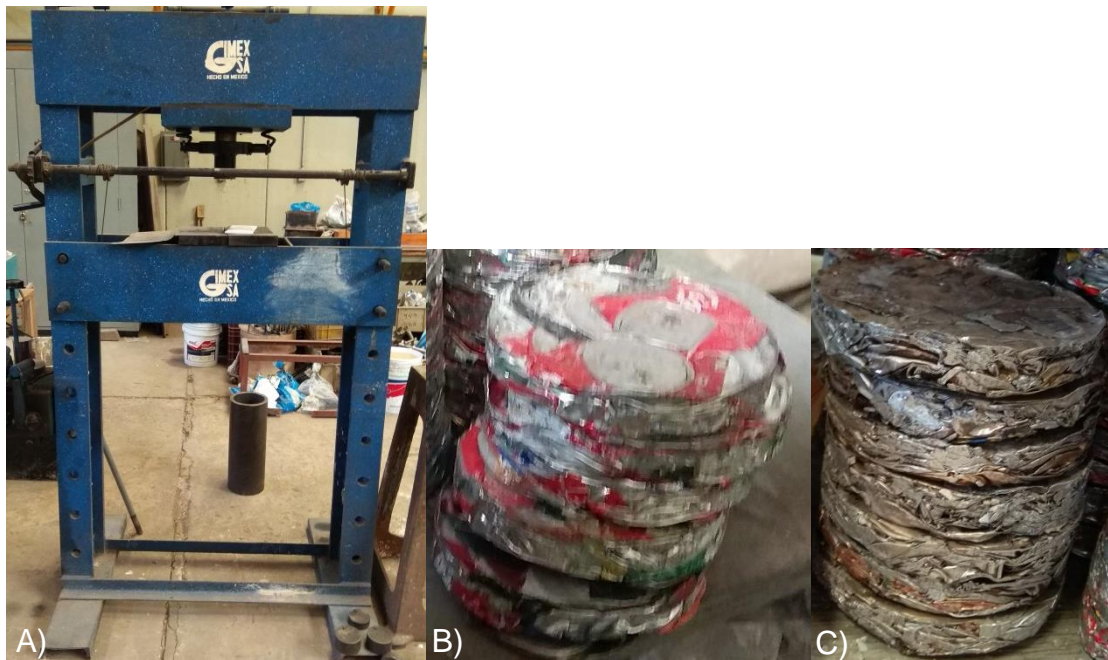
Figura 2.2 – A) Prensa Hidráulica usada para fabricar pacas, B) Pacas de latas con pintura, C) Pacas de latas con pintura parcialmente quemada.
