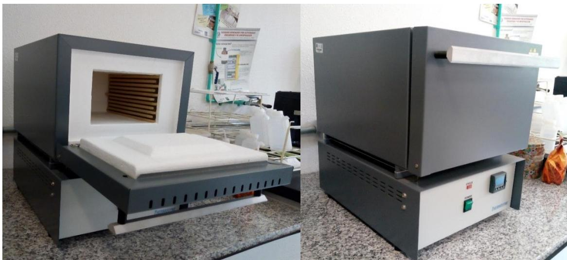
**Figura 11.** Mufla de la marca THERMOLYNE, tipo 47900.
