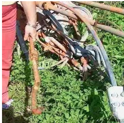
Figura 1.8. Anclaje tras el paso del huracán Michelle.
