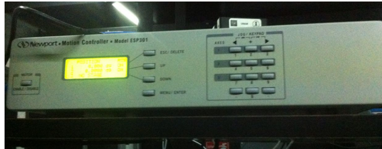
FIGURA 3.1: Controlador Newport modelo ESP301 utilizado para manejar los motores en el arreglo experimental.
