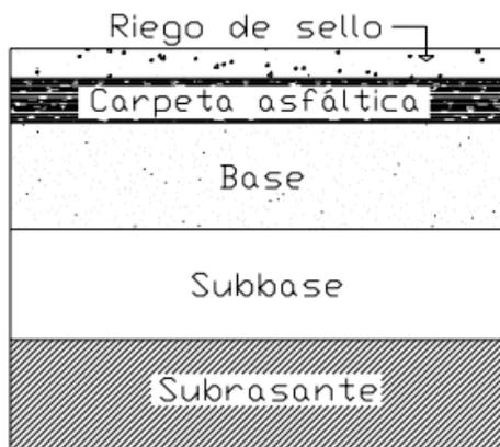
Figura 2.1 Capas que forman un pavimento flexible.
