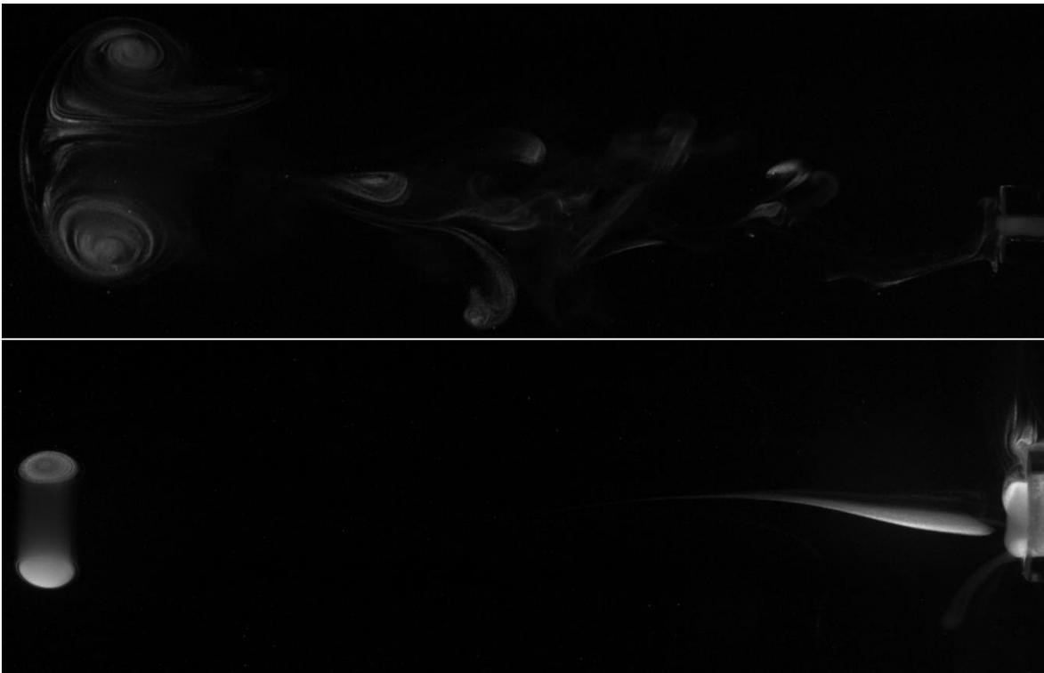
Figura 3.2. Estelas. La figura superior corresponde a la estela del vórtice formado por la tobera plana, la inferior al toroidal.
