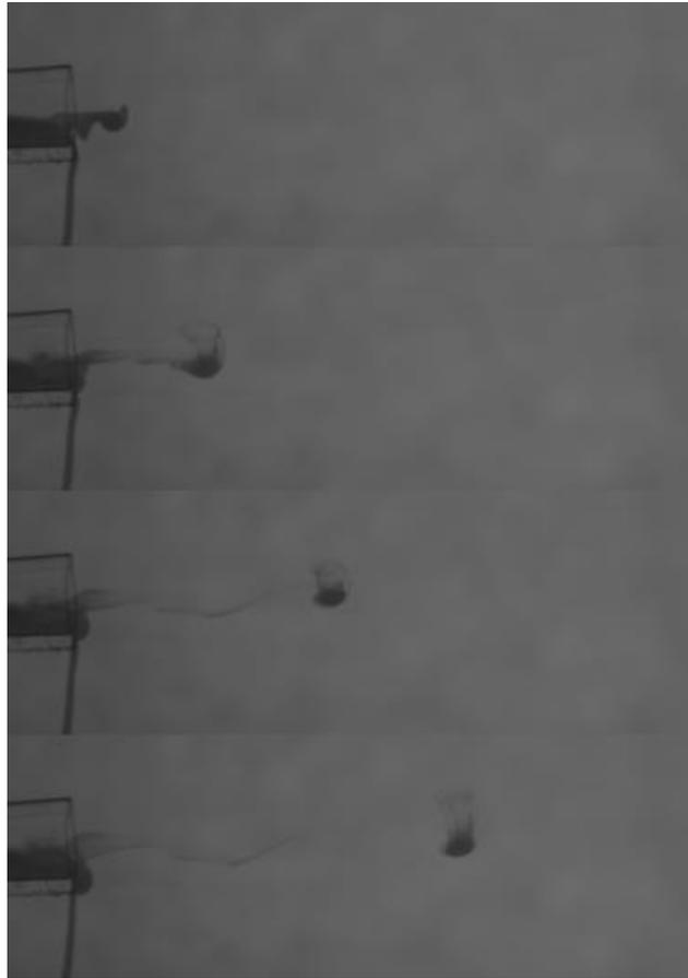
*Figura 3.8. Secuencia de evolución del vórtice formado con la tobera elíptica. La secuencia corresponde (de arriba abajo) a los tiempos 0.093 s, 0.276 s, 0.716 s y 1.666 s.*
