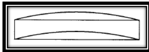
Figura 1.12 Deformación de la planta del edificio.
