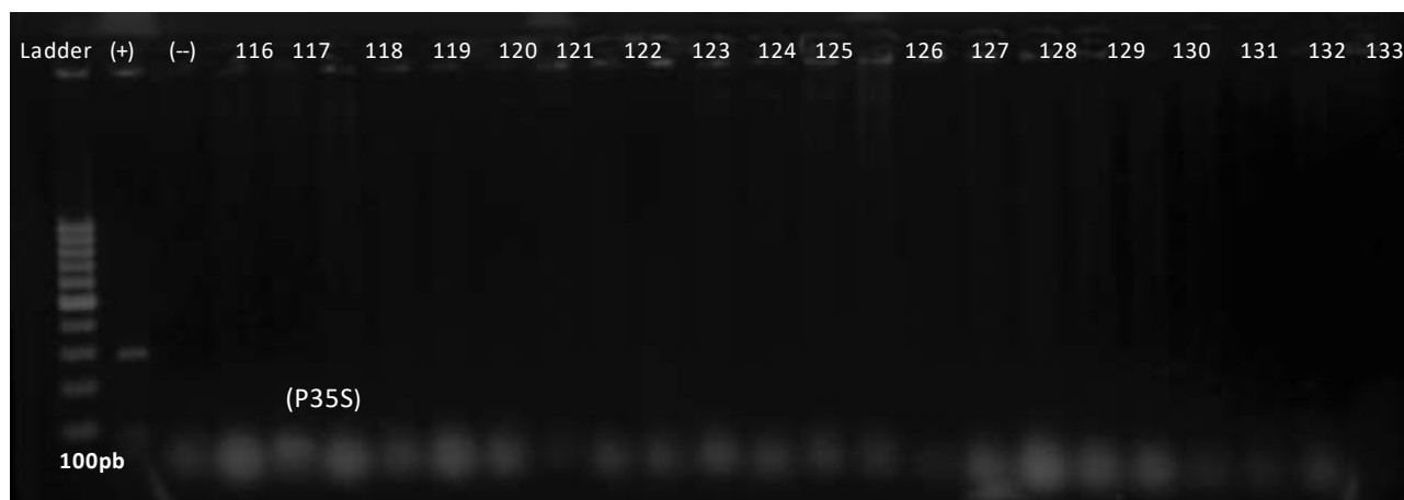
Figura 13. Gel de agarosa al 2% de los amplicones del gen P35S en pools de DNA. Carril 1: marcador de peso molecular de 100 pb. Carril 2: control positivo del gen P35S (195pb) de papaya transgénica evento 55-1. Carril 3: control negativo. Carriles 4-25: muestras en pools de DNA analizadas (116-137).
