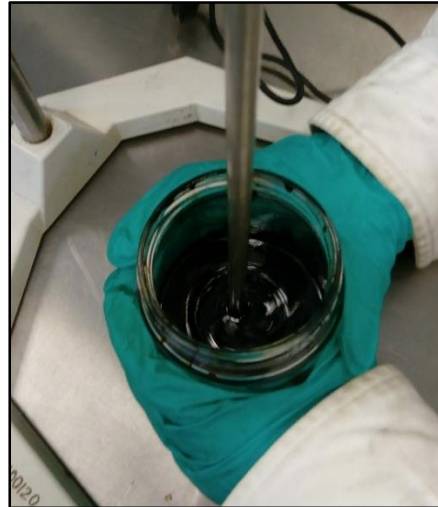
Figura 3- 27. Homogeneización de la muestra de aceite a una concentración del 1% de aceite Gamma.
