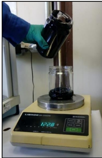
Figura 3- 26. Medición del aceite Sigma para la preparación de las diferentes diluciones.
