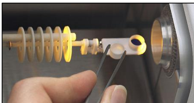
Figura 3- 4. Crisoles de PCA, (Alúmina) en donde se colocaron las muestras de aceite para las pruebas experimentales DSC – TGA 3+ ( www.mt.com ).
