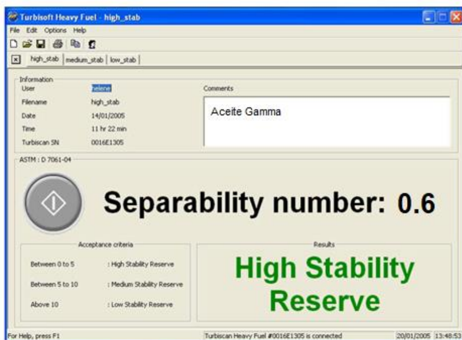
Figura 3- 23. Resultado obtenido del análisis de estabilidad del Aceite Gamma.
