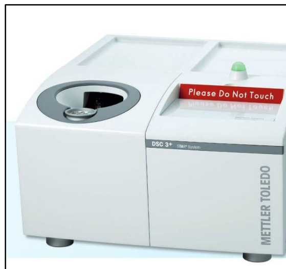
Figura 3- 5. Equipo experimental DSC 3+ (www.mt.com).
