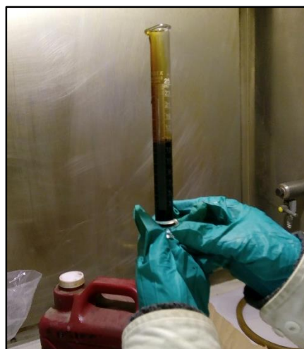
Figura 3- 25. Medición del aceite Gamma para la preparación de las diferentes diluciones.
