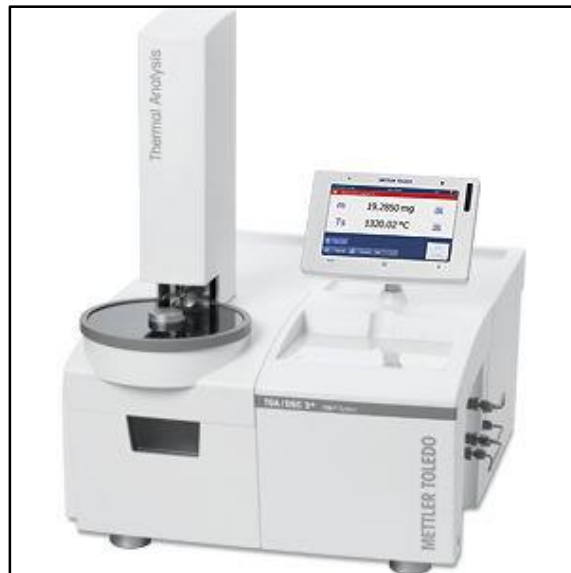
Figura 3- 3. Equipo experimental DSC – TGA 3+ ( www.mt.com ).
