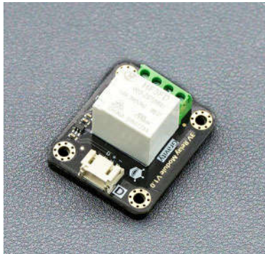
Figura 9-18 Fotografía del módulo del relevador de 10A (DFRobot, 2018f)
