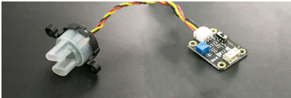
Figura 9-13 Fotografías del sensor de turbiedad SEN189(derecha) y la placa de conversión (izquierda) (DFRobot, 2018d)
