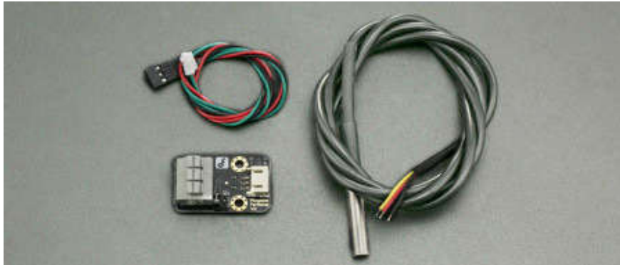
Figura 9-16 Fotografía del sensor de temperatura DS18B20 (derecha) y la placa de conversión (izquierda) (DFRobot, 2018e)
