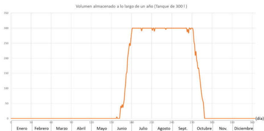
Figura 4-3 comportamiento del sistema con un volumen de almacenamiento de 300 litros
