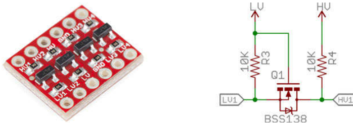
Figura 9-21 Fotografía del convertidor lógico (izquierda) y diagrama electrónico del mismo (derecha) (Sparkfun, 2018c)
