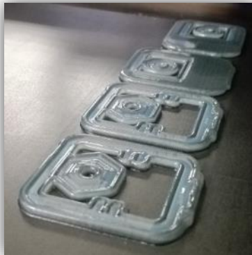
Figura 3.4 Irregularidades en la superficie de prototipos.
