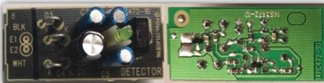
Figura 2.11 Vista superior e inferior de la PCB del circuito eléctrico emisor.
