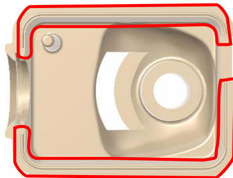
Figura 3.35 Guías de soldadura en la carcasa superior.
