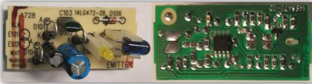
Figura 2.12 Vista superior e inferior de la PCB del circuito eléctrico receptor.
