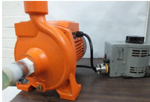
Figura 3.1. Conexión de la bomba y variac.
