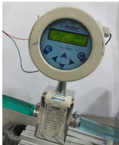
Figura 3.2. Medidor de flujo en la entrada de la placa.
