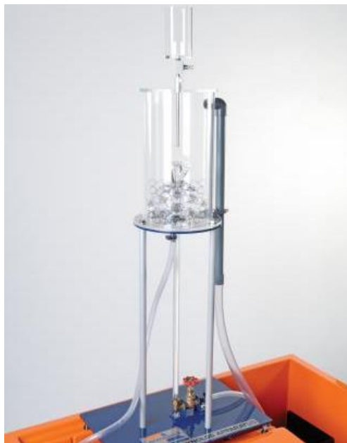
Figura IV. Equipo Armfield para demostración del experimento de Reynolds.
