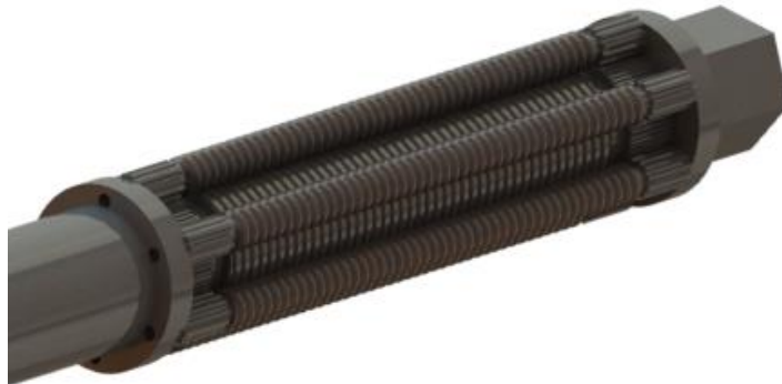
Figura 1.3. Dibujo que muestra las proporciones requeridas del tornillo impulsor, no disponible comercialmente.
