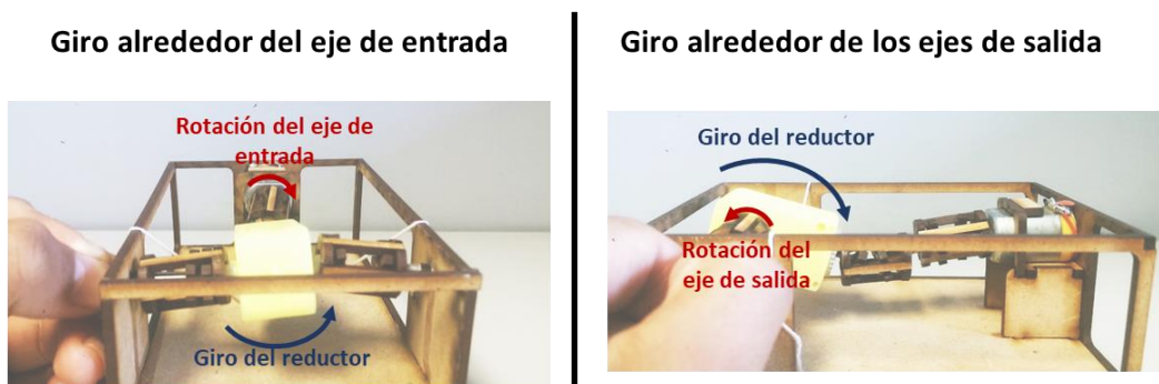
Figura D.5. Giros en el reductor cuando el eje de entrada rota en sentido antihorario.
