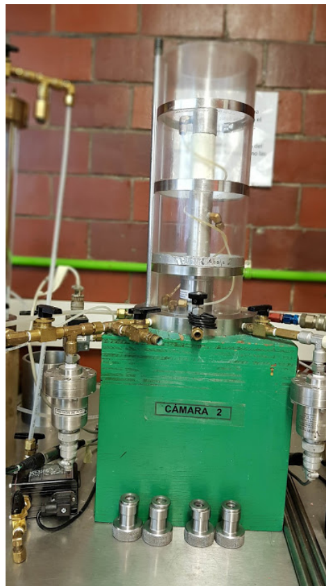
Figura 2.2: Cámara triaxial del laboratorio de mecánica de suelos
