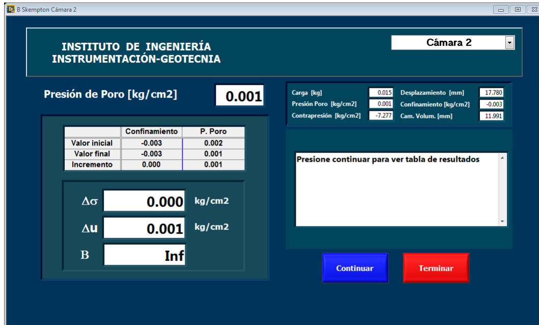
Figura 5.13: Lectura y cálculo de la B de Skempton
