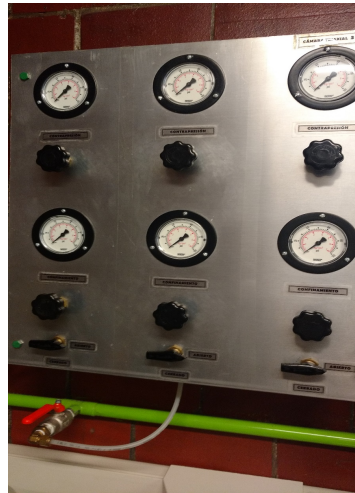
Figura 5.9: Panel de control de cámaras, dos reguladores de presión y dos manómetros de carátula se reemplazaron por una interfaz gráfica en el software realizado
