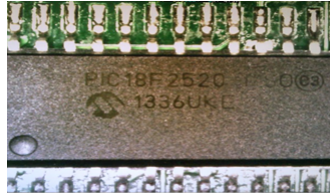
Figura 2.16: Microcontrolador de una tarjeta controladora visto bajo un microscopio
