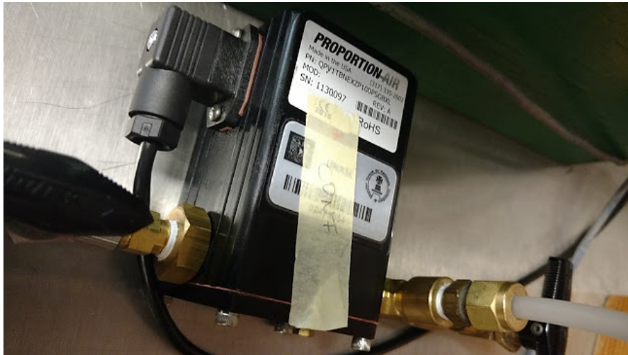
Figura 2.21: Servo válvula de prueba conectada al sistema de aire
