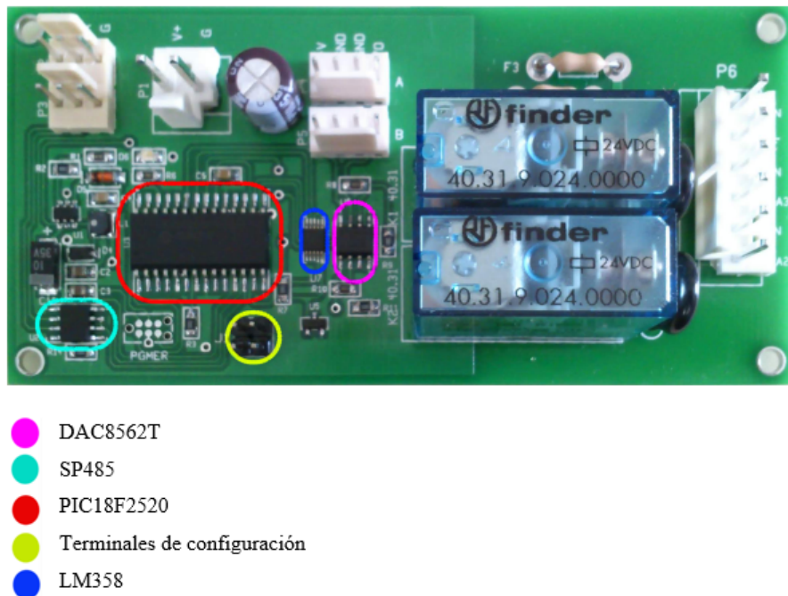
Figura 2.15: Identificación de los componentes de la tarjeta controladora
