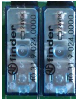
Figura 2.20: Vista superior de los relevadores en la tarjeta controladora
