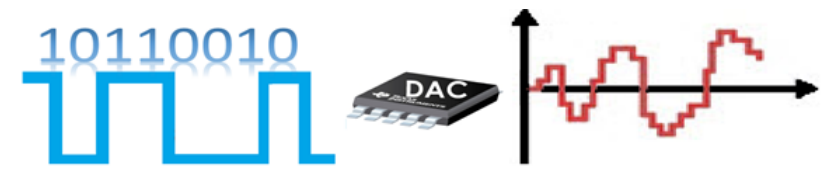
Figura 2.6: Ilustración de una conversión de señal digital a señal analógica
