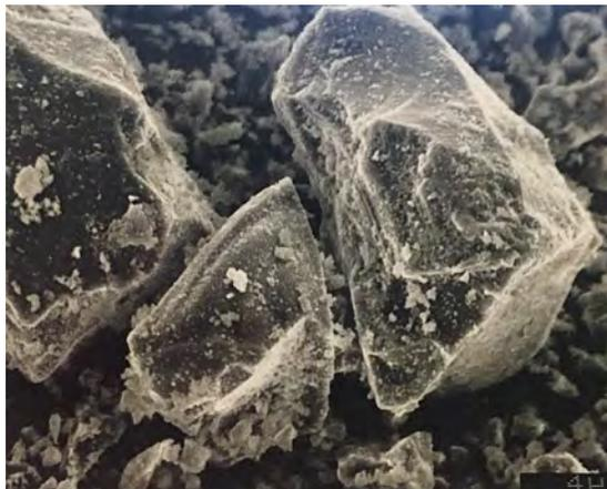
Figura 3 Partículas de relleno de cuarzo triturado empleadas en las primeras fórmulas de las resinas compuestas tradicionales.
