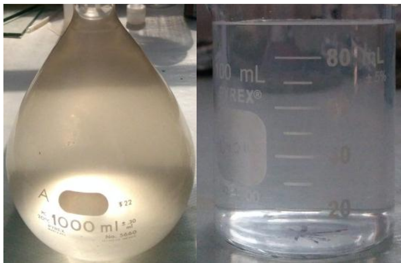
Figura 19. Comparación de agua antes (izquierda) y después (derecha) de inactivación fotocatalítica
