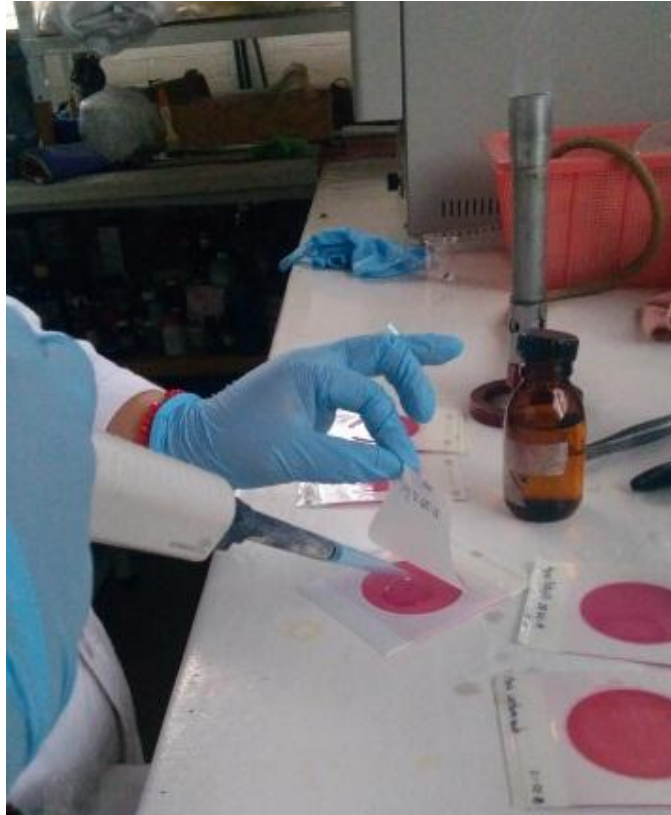
Figura 18. Inoculación de placa para recuento de coliformes totales, 3M® Petrifilm™.
