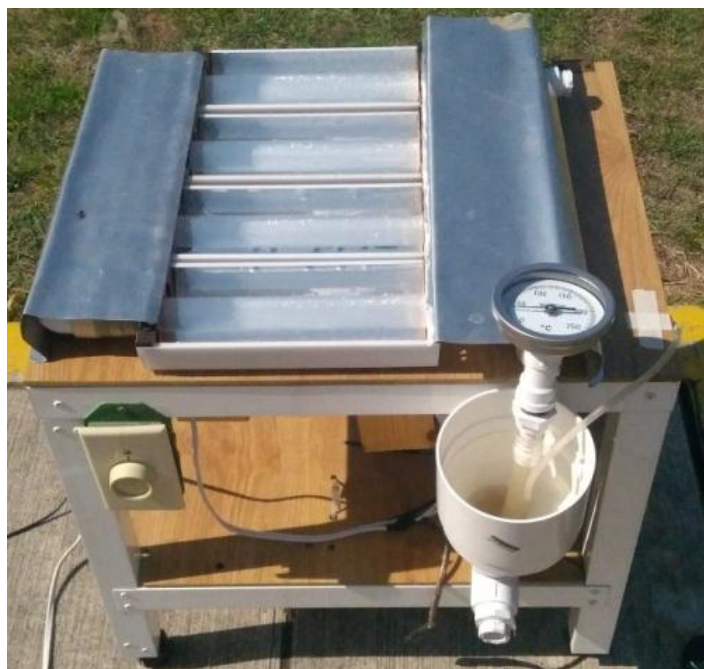
Figura 16. Reactor fotocatalítico tipo CPC.
