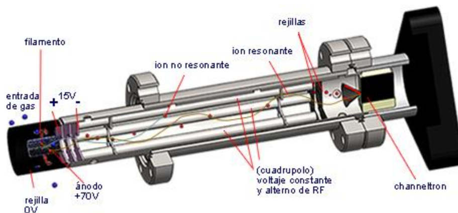
Figura 17. Esquema de un analizador másico del tipo cuadrupolar tomada de URL: http://minilink.es/3yk8 consultada por última vez 07/04/19
