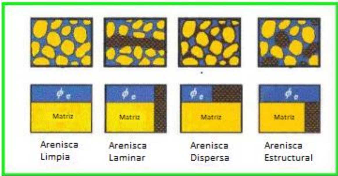
Figura 3. Este esquema muestra los tipos de distribución de arcilla en una arenisca. Modificado de Petrophysics Distant Learning Module, Schlumberger (1999).
