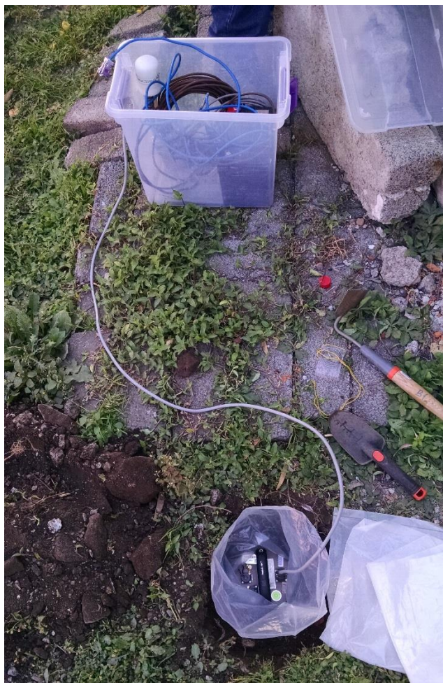
Figura 14 Sismómetro de banda ancha Güralp® CMG-6TD orientado hacia el norte magnético y conectado a una batería que funge como fuente de alimentación y a un dispositivo GPS.
