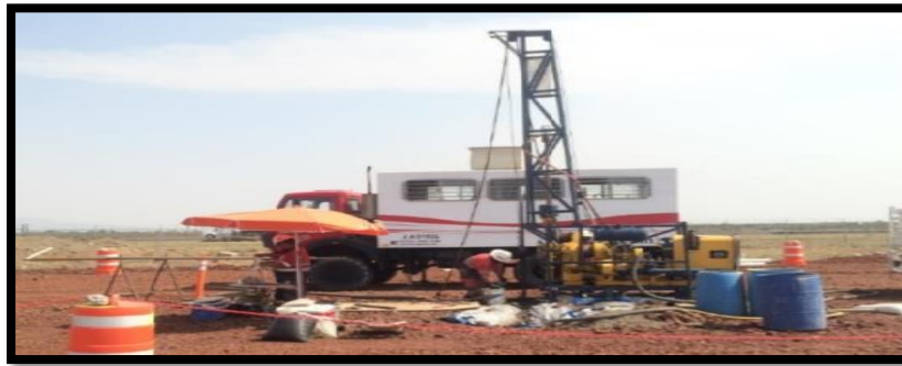
Figura 3. 7 perforadora Long year 34 para la prueba de penetración estándar (11)
