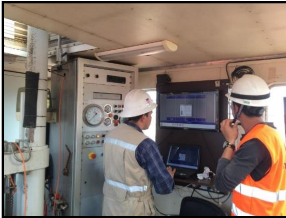
Figura 3. 19 Programación de la prueba de veleta en la computadora (22)
