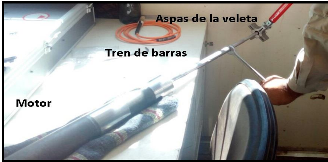
Figura 3. 2 Partes de una veleta digital en proceso de ensamblado (16)
