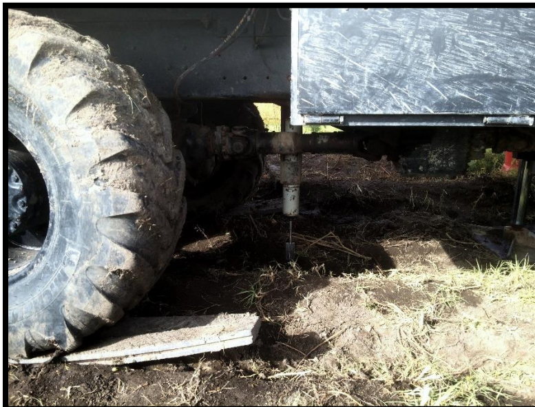
Figura 4. 27 Obtención de la medición cero para las pruebas de veleta digital (31)
