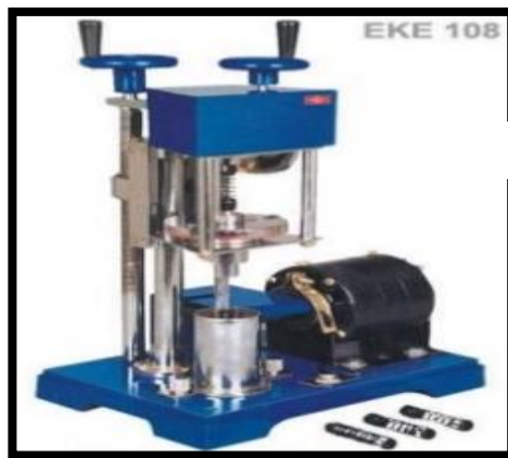
Figura 2.8 Dispositivo de veleta de laboratorio (8)
