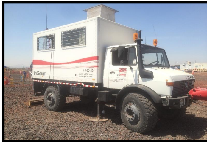
Figura 4. 11 Vista del camión Hydson 100 kN preparado para la prueba de veleta digital (25)
