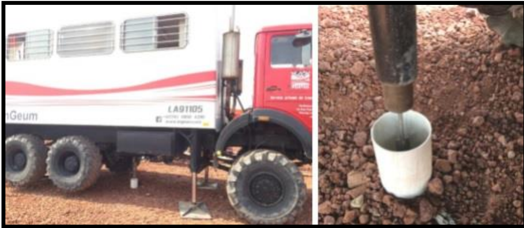
Figura 3. 14 Camión sobre superficie de tezontle y ademe de PVC (20)
