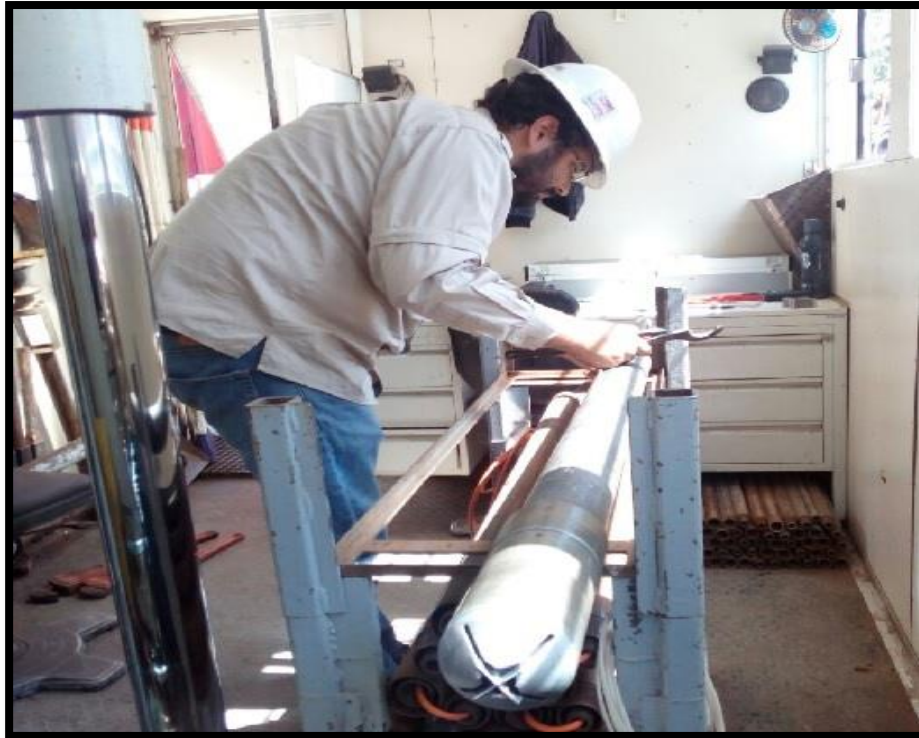
Figura 3. 3 Tubo guarda ensamblado para la prueba de veleta digital (17)
