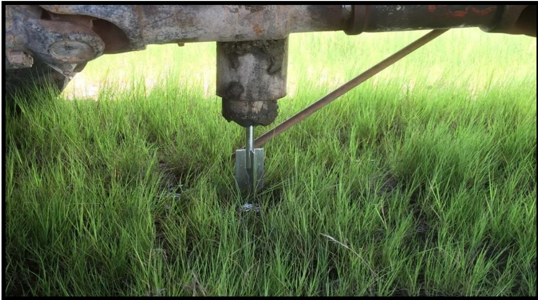
Figura 4. 2 Toma de la lectura de ceros para inicio de la prueba de veleta (19)
