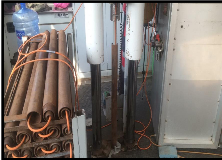
Figura 4. 26 Máquina de hincado y tren de tubos metálicos de hincado (31)
