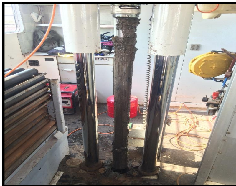
Figura 4. 22 Extracción de la veleta llena de arcilla adherida en la superficie. (29)
