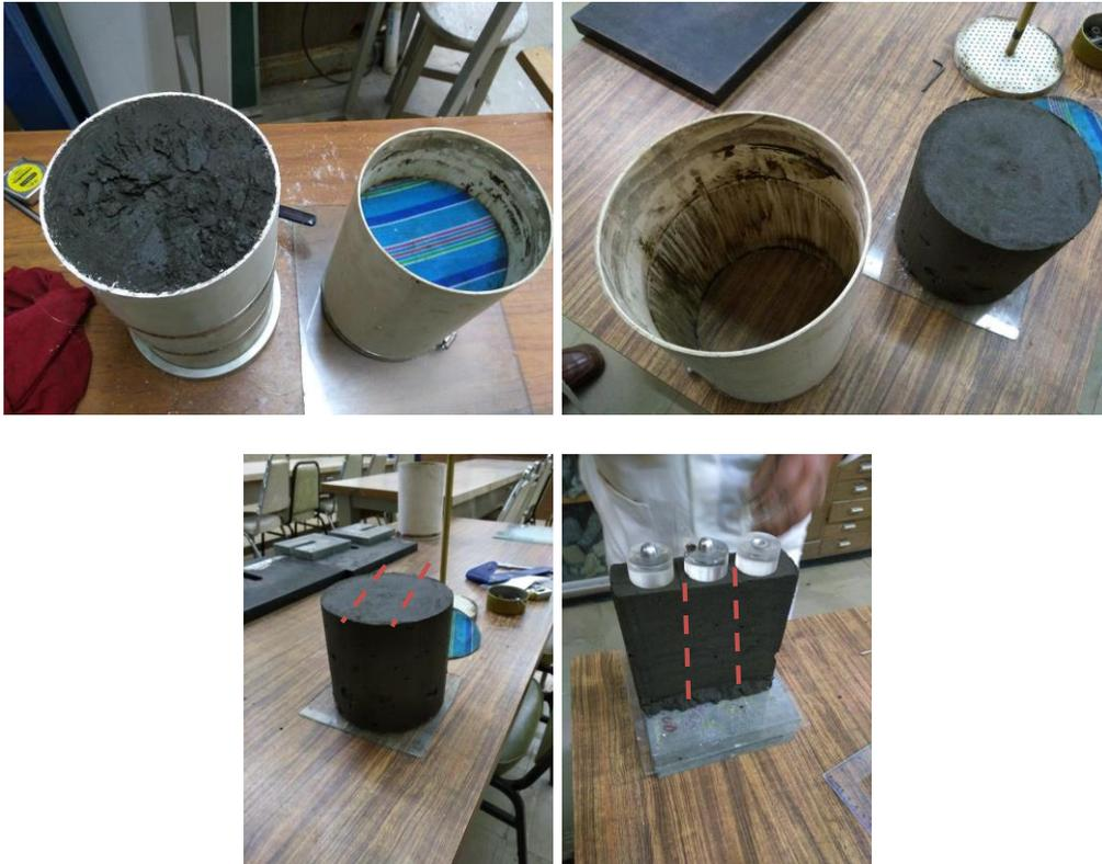
Figura 61.- Extracción de la muestra
