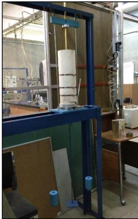
*Figura 40.- Arreglo del marco de carga*
