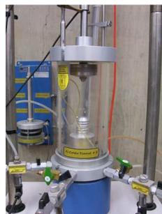
Figura 54.- Cámara triaxial y plato base.
