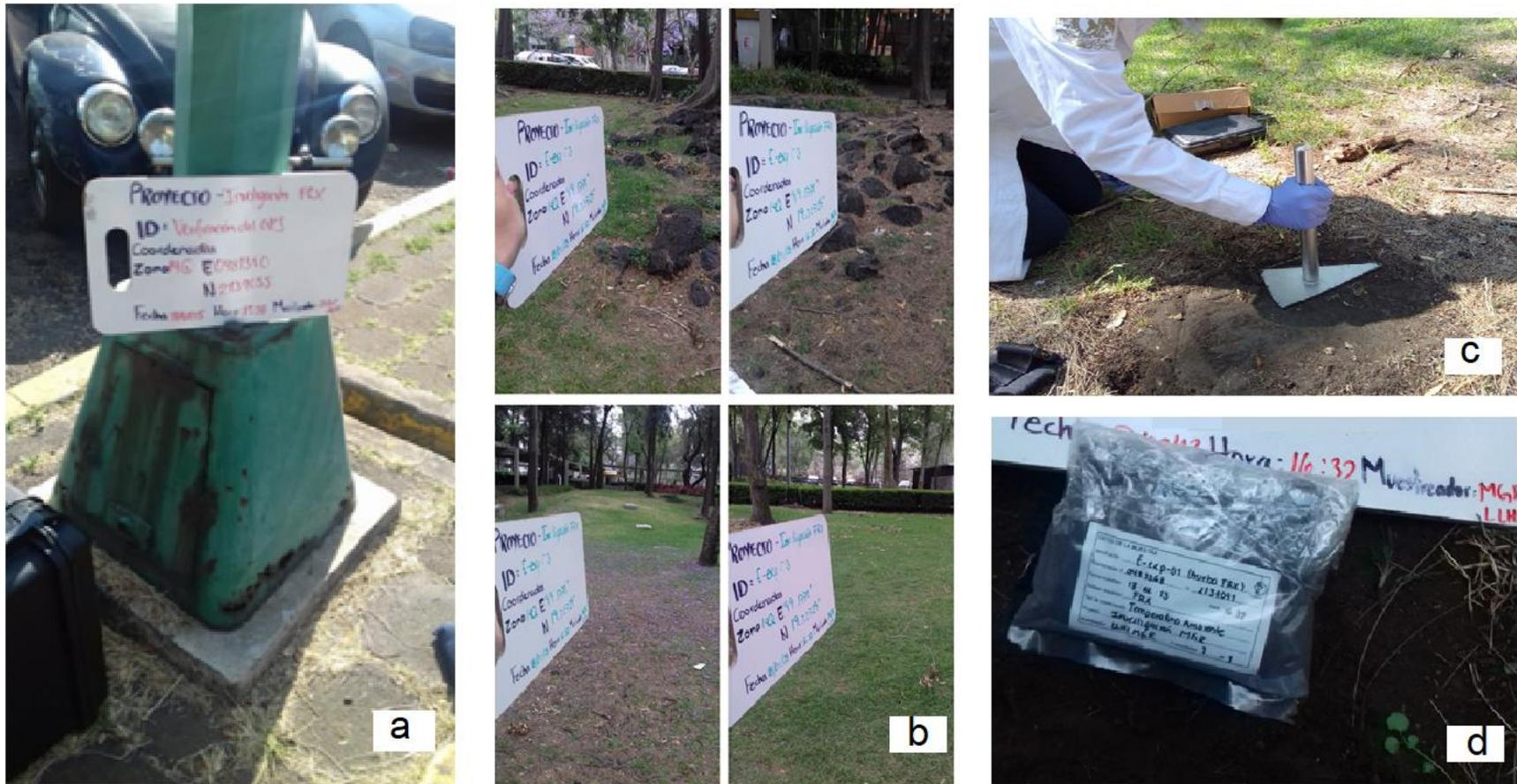
Figura 13. (a) Verificación del GPS. (b) Registro fotográfico del punto de análisis. (c) Preparación de la superficie del suelo a analizar. (d) Toma de una muestra para análisis en el laboratorio
