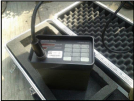
Fig. [17]. Magnetómetro de protón Modelo G-856, Geometrics.
