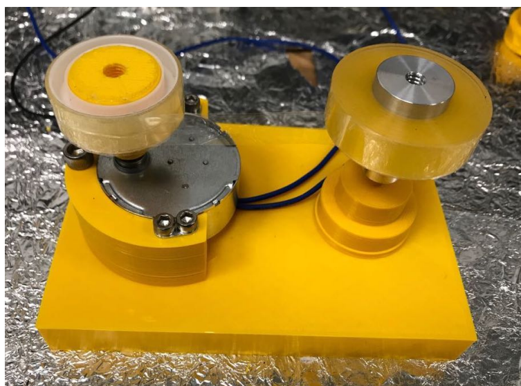
Figura 5-13: Sistema diseñado para enrollar la cinta en su base original.
