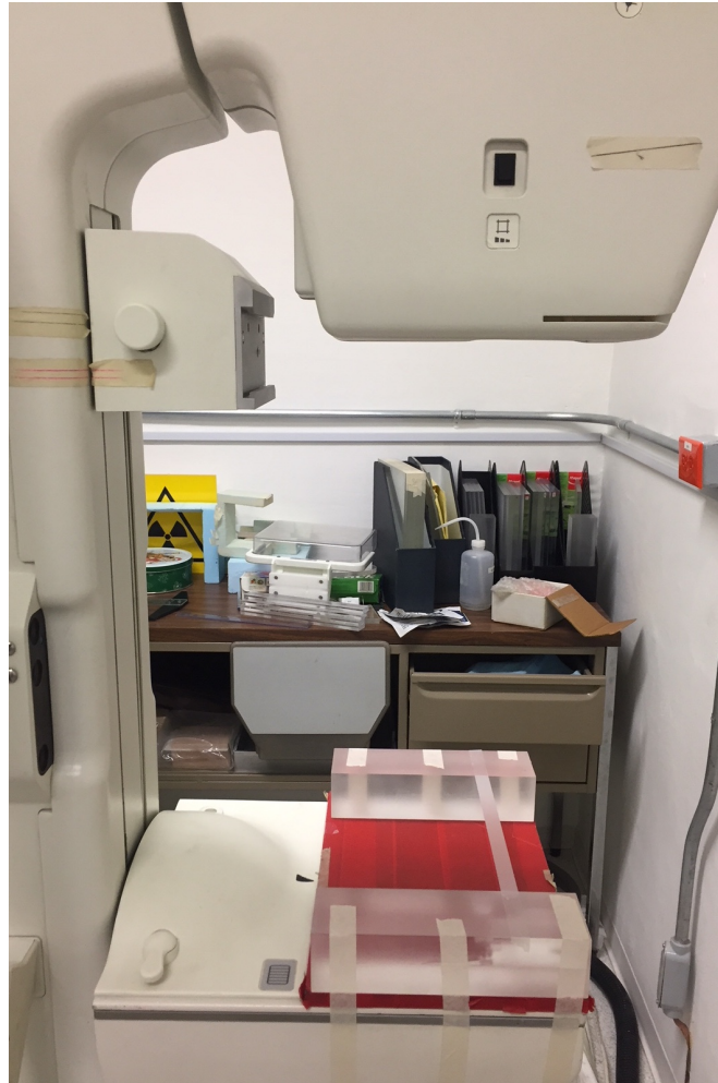
Figura 5-8: Montaje para calibración de los dosímetros TLD en el mamógrafo.
