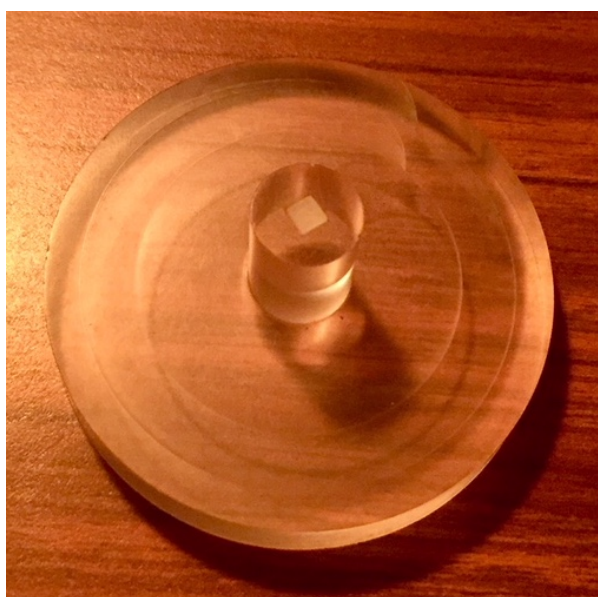
Figura 5-2: Soporte de lucita de la fuente de ^{90}\text{Sr}/^{90}\text{Y} para dosímetros de 3.2 \times 3.2 \times 1 mm.
