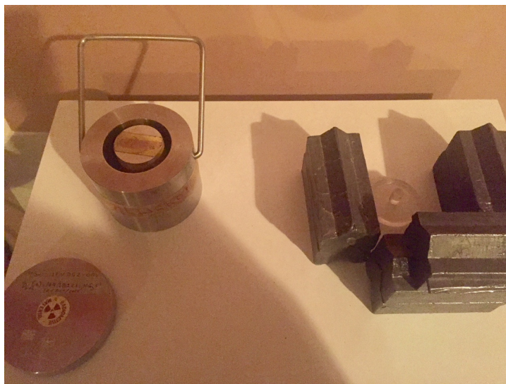
Figura 5-3: Fuente de ^{90}\text{Sr}/^{90}\text{Y} dentro de su contenedor y blindaje de plomo.
