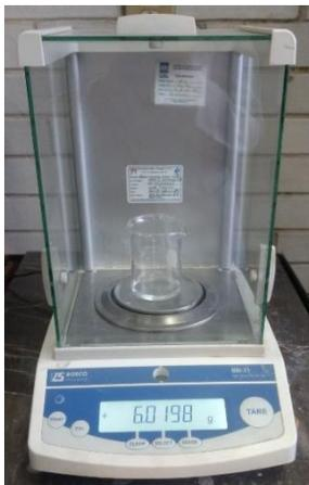
Figura 5 balanza calibrada F.D.
