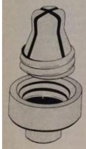
Figura 27 La sección macho del atache Ceka® debe desenroscarse y reemplazarse si es necesario. 3
