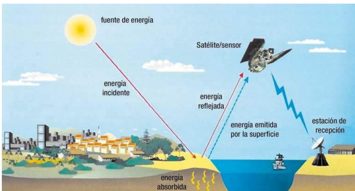
Figura 1. Elementos en la adquisición de información en teledetección. Fuente: Calvache Ulloa (2004).
