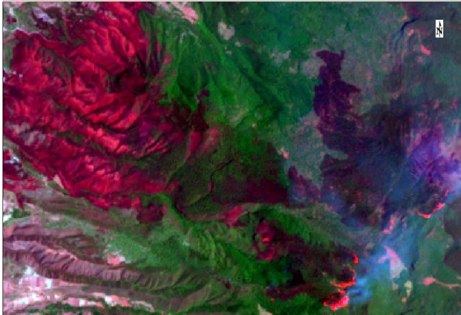
Figura 15. Segmento de imagen Landsat TM 5 del 9 de abril de 1998, con la composición de falso color (7, 4, 3) en donde se aprecian las cicatrices de quemado en color rojo escarlata y magenta provocadas por un incendio forestal. Incluso con esta combinación de falso color es posible apreciar el fuego en color naranja-rojizo.
