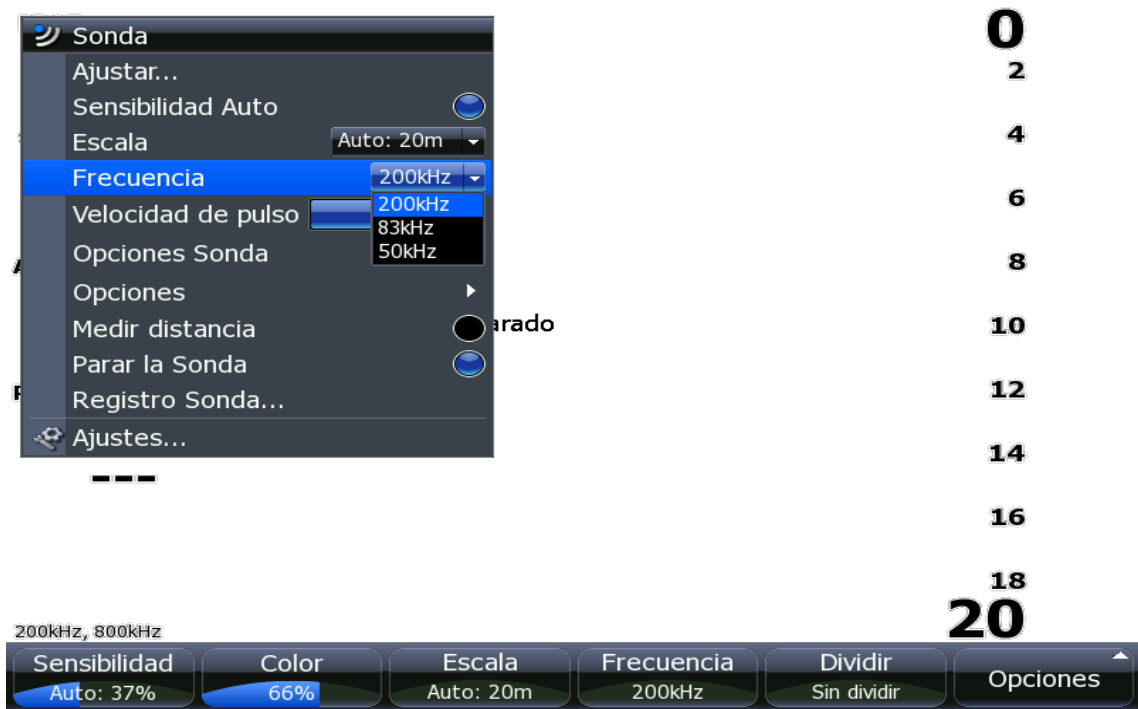
Fig. 4. Frecuencia disponible de la ecosonda. Esta frecuencia se ajusta preferentemente a 200 KHZ
