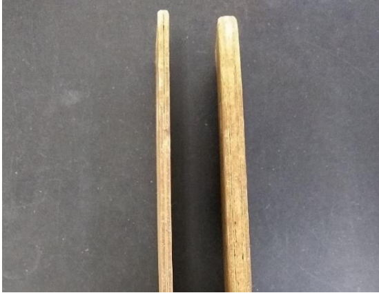
Fig. 2 Diferentes grosores de vigas (6 mm y 12 mm).
