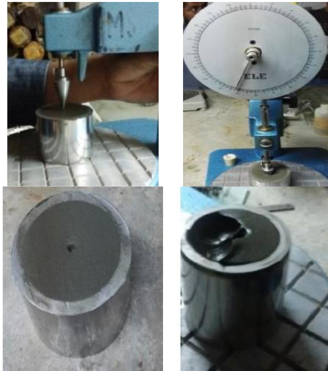
Figura 83. Determinación del límite líquido utilizando el cono inglés.
