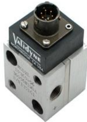
Figura 51. Sensor de cambio volumétrico (presión diferencial).
