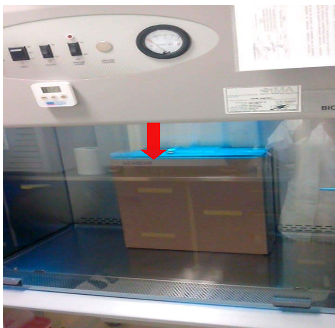
Figura 10. Posición de la placa dentro de la campana la cual esta indica con la flecha
