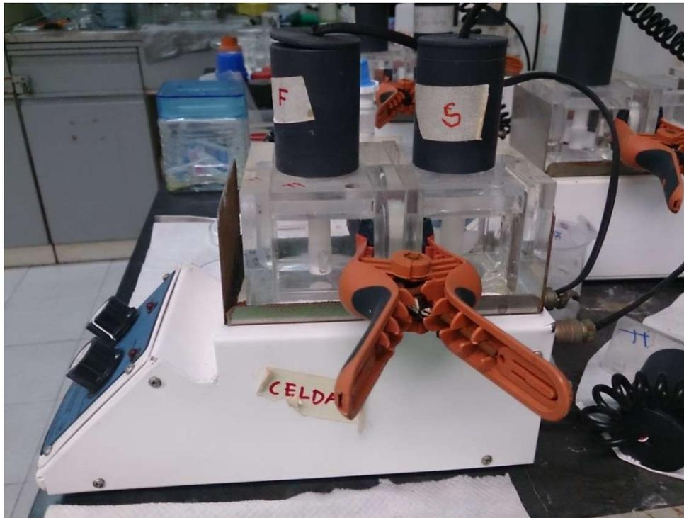
Figura 6.12. Celda de difusión empleada para realizar los experimentos de transporte de MeOH y EtOH
