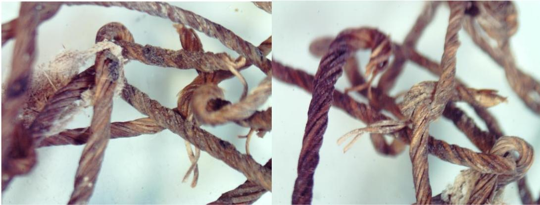
**Figura 10.** Imágenes del microscopio de la muestra LEMA-1018 en la que se puede apreciar la presencia de hongos.
