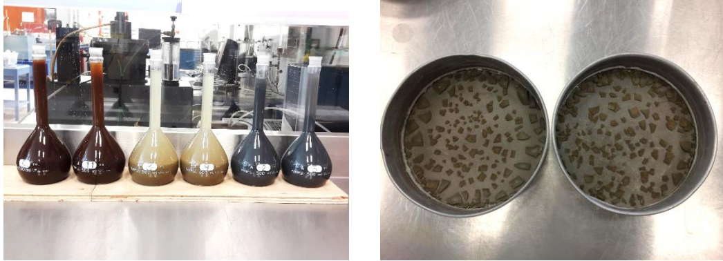
Figura 3.3. Determinación de la densidad de sólidos.
