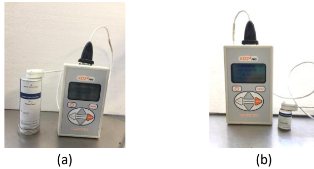
Figura 3.12. a) Calibración de la aguja simple con silicón epóxico. b) Calibración de la aguja doble con bloque de Delrin.
