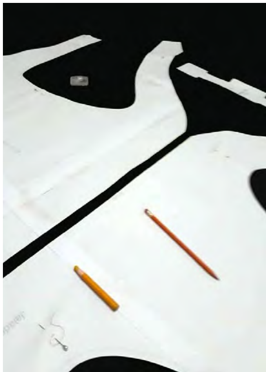
Moldes sobre tela para trazo y corte de la pieza. Foto: Berenice González (México, 2018)
