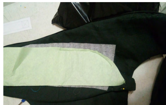
Tela, espumado y minifold para evitar deslizamiento durante la costura. Foto: Berenice González (México, 2018)
