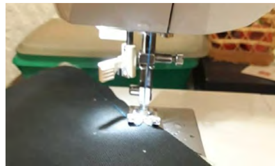
Máquina de costura recta para unión de piezas. Foto: Berenice González (México, 2018)
