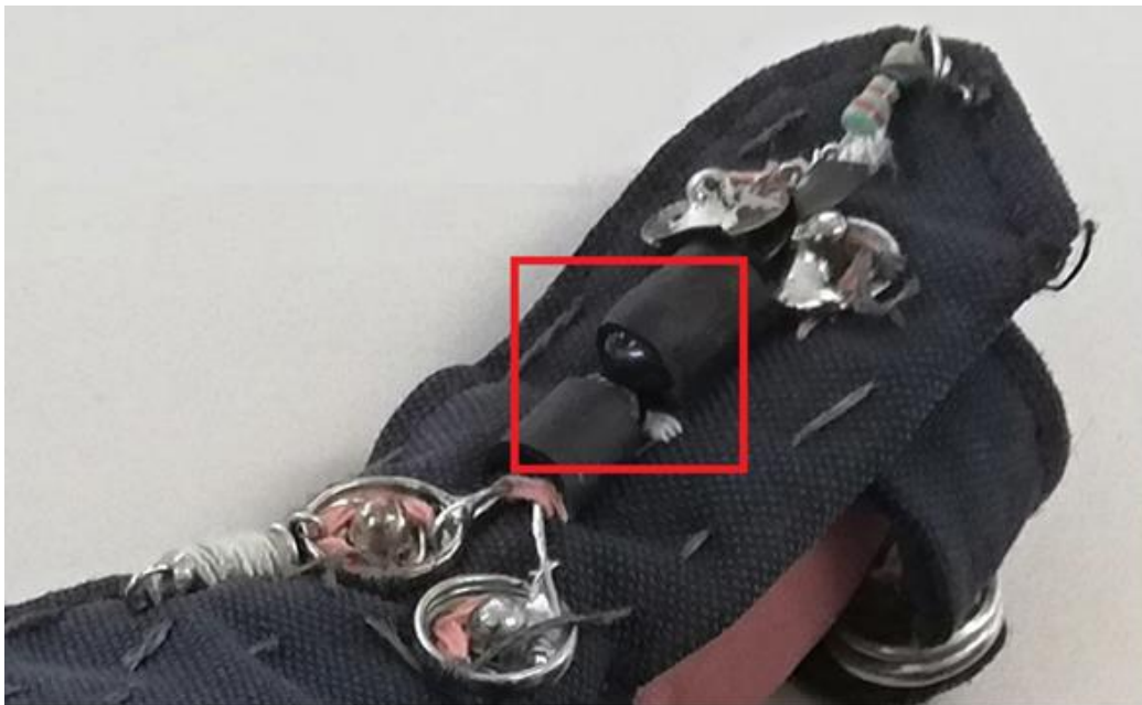
Figura 60. Fotografía del guante de sensado, dentro del marco rojo se puede observar que la distancia entre los sensores es prácticamente de cero.
