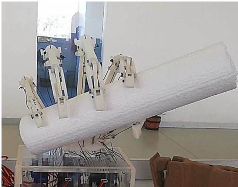
Figura 76. Vista frontal de la mano mecatrónica antropomórfica haciendo la sujeción palmar de un cilindro.
