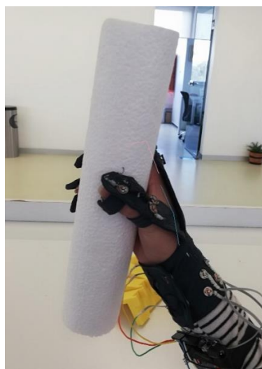
Figura 83. Sujeto de pruebas sosteniendo un cilindro. Se puede observar también el ángulo más significativo para este movimiento, es importante mencionar que los sensores también pueden medir este cambio significativo al realizar este movimiento de sujeción.
