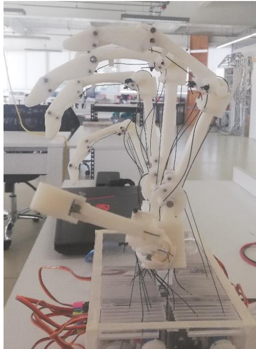
Figura 66. Vista lateral de la mano mecatrónica donde se observan los espirales que convergen en un punto.
