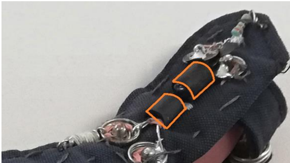
Figura 62. Sensores recubiertos con termofit. El termofit se ajustó a los sensores, al no ser estorboso no se nota a la hora de doblar la mano y logra que el guante cuente con mayor exactitud.
