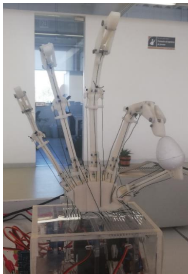
Figura 70. Vista frontal de la mano mecatrónica antropomórfica realizando la sujeción bidigital de un huevo de unicel.
