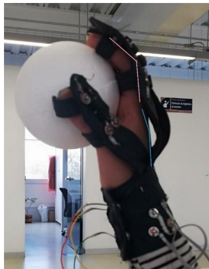
Figura 81. Mano sosteniendo una pelota vista lateralmente. Se comprueba que el ángulo que más cambia es el de la falange media-proximal, el cual está señalado por el ángulo marcado con color rosa, este ángulo es el más importante para el movimiento de flexión, mientras que, el ángulo marcado con azul, no se puede medir por el guante, pero por su magnitud puede ser despreciado.
