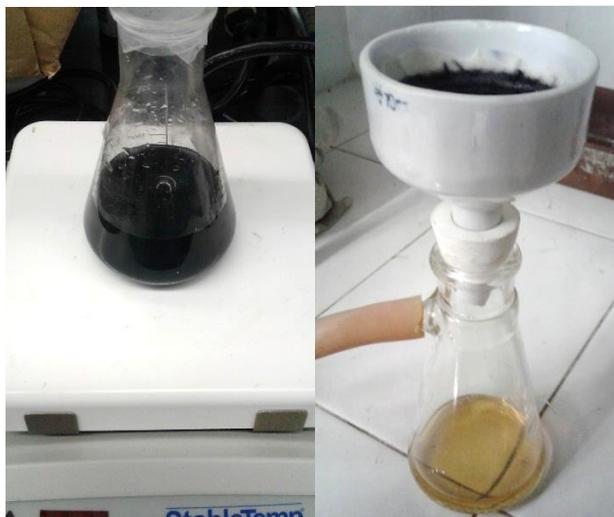
**Figura 10. Filtrado de carbón activado**
