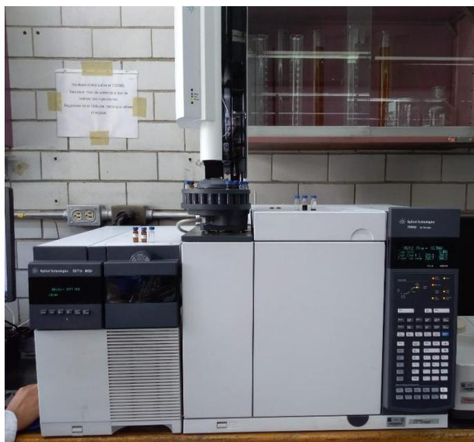
**Figura 7. Cromatógrafo “Agilent Technologies”**
