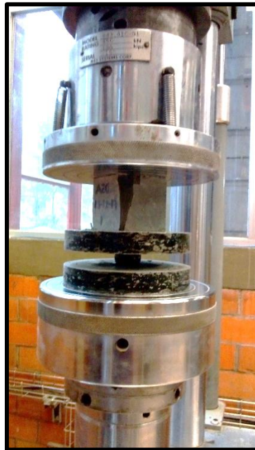
Figura 2.5 Prueba de resistencia a la compresión.
