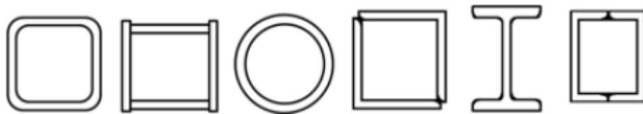
Figura.3. 7. Tipo de secciones de los Contraventeos Convencionales (Gerdau Corsa, 2013)
