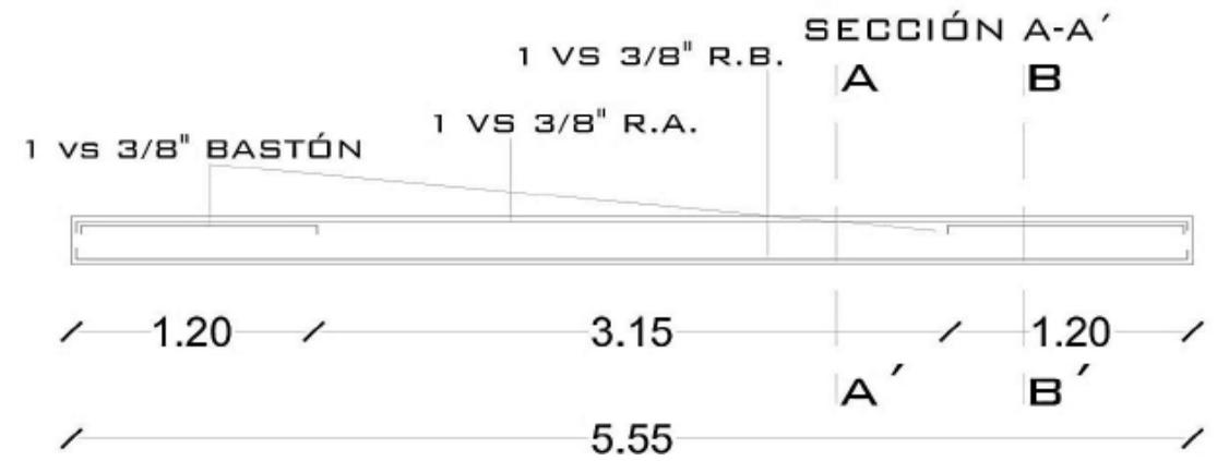
**CÁLCULO DE LOSA NERVADA DE 0.25 M DE ESPESOR:**
