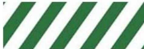
FRANJAS DE SEGURIDAD PARA INDICAR UNA CONDICIÓN DE EMERGENCIA
