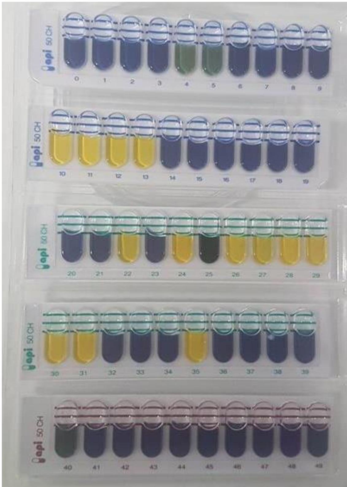
Figura 148. Tira API® 50 CH de la cepa 2F tras 24 h de incubación a 30 \pm 2^\circ\text{C}
