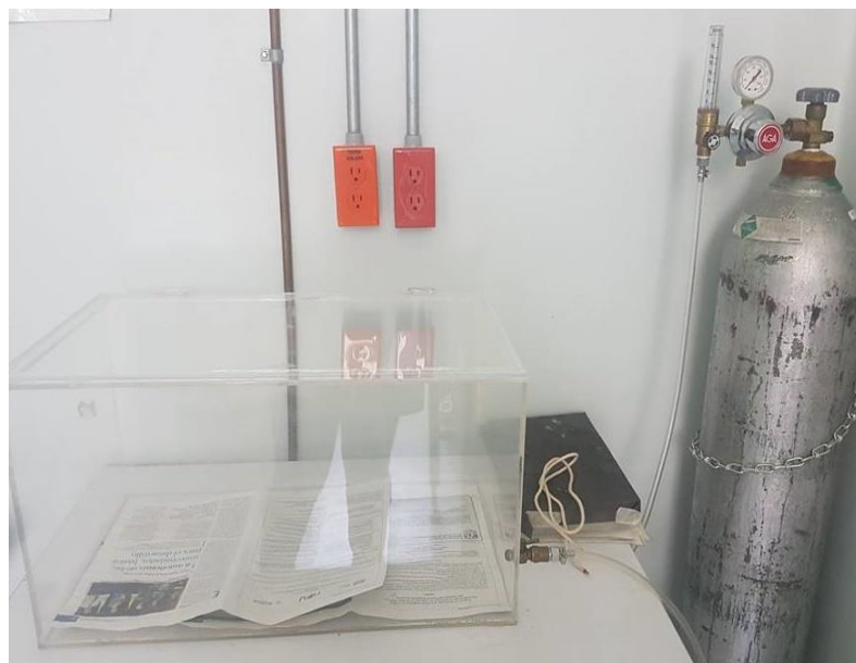
Figura 13. Cámara de CO 2
