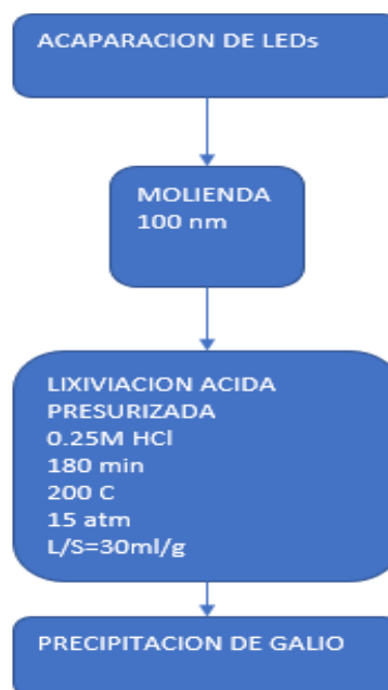
Figura 6-7 Proceso de reciclaje del Galio a partir de los módulos LED (Chen,2018)
