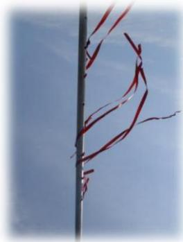
Fig. 15. Varilla con cintas para determinar la dirección de corriente.
