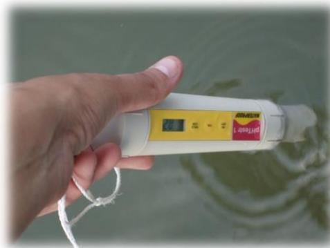
Fig. 14. Determinación del pH, con el potenciómetro.
