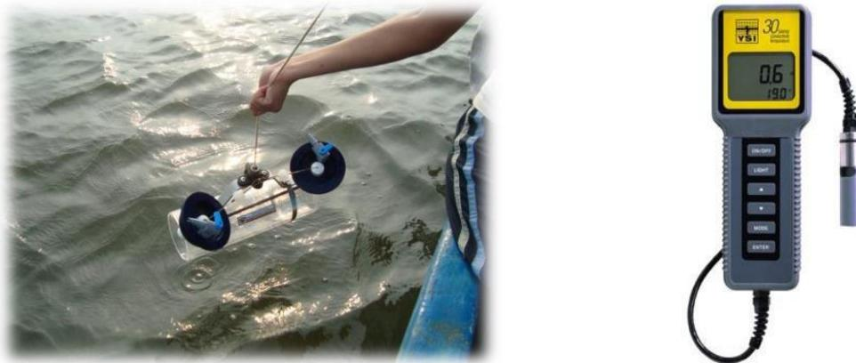
Fig. 12. Botella de van Dorn y multisensor YSI 30.
