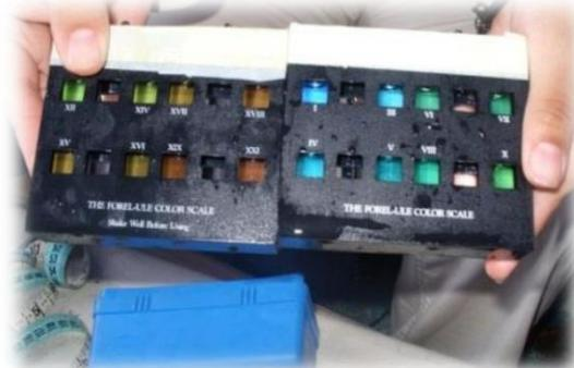
Fig. 17. Medición de agua con escala de Color Forel-Ule, 5907.
