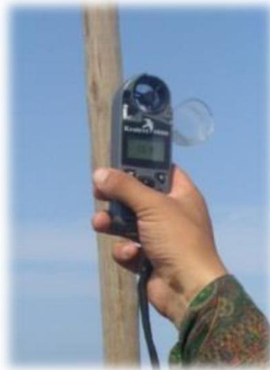
Fig. 8. Estación Climática Kestrel 4000.
