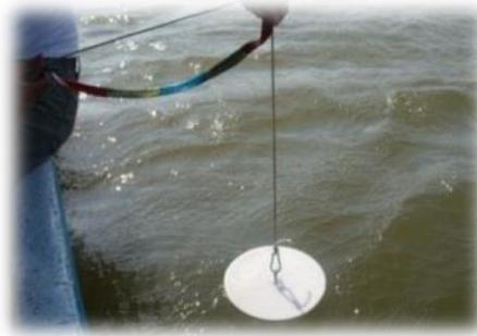
Fig. 11. Disco de Secchi LaMotte.
