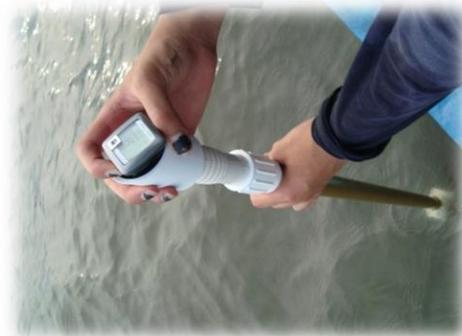
Fig. 16. Flujómetro digital 30A-60 para determinar de la velocidad de corriente.
