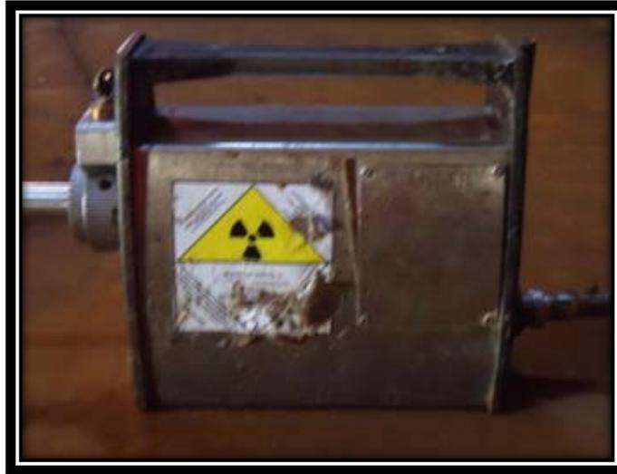
Figura 7. Fuente Radiográfica.
