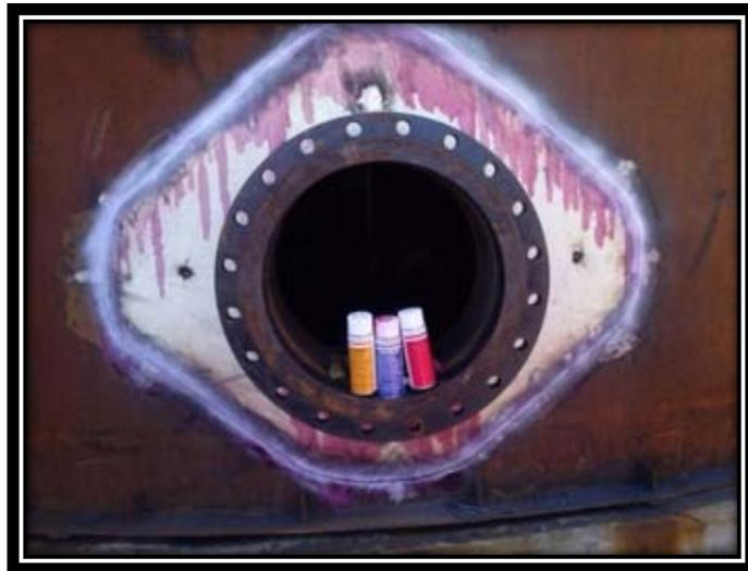
Figura 44. Aplicación de Líquidos Penetrantes en toda soldadura de filete.
