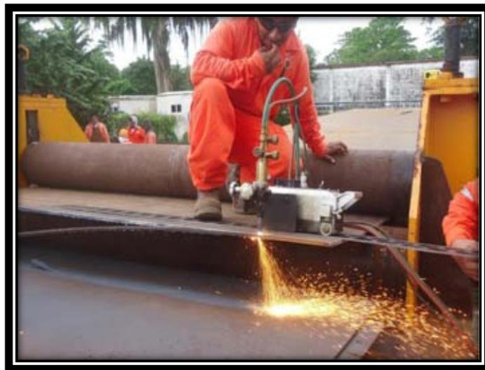
Figura 17. Corte y escuadrado de las placas envolvente.
