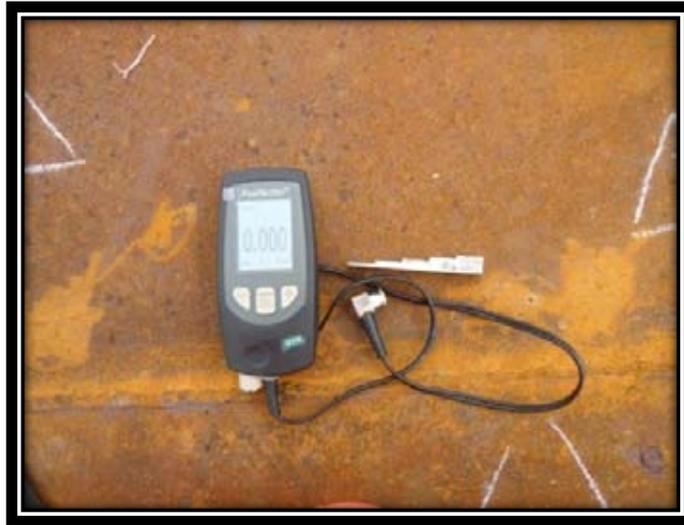
Figura 6 Equipo Ultrasonico positector UTG.
