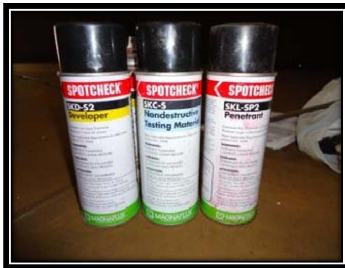
Figura 5. Líquidos penetrantes Tipo II Método C
