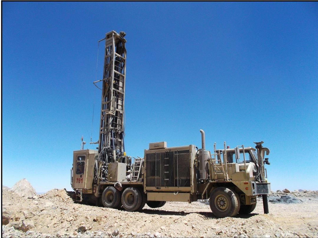
**Figura 62 Operación del Equipo de Perforación a Rotación**
