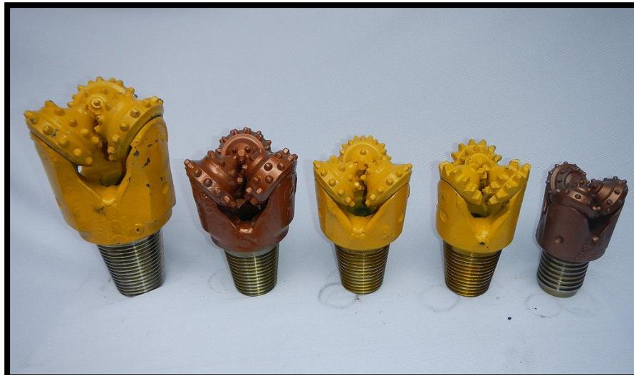
**Figura 61 Tipos de Brocas utilizadas en el Método de Rotación (Tricónica y Drag)**
