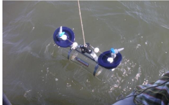
Fig. 8. Botella de Van Dorn para características hidrológicas de fondo.
