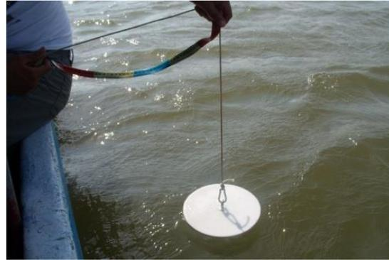
Fig. 10. Disco de Secchi.
