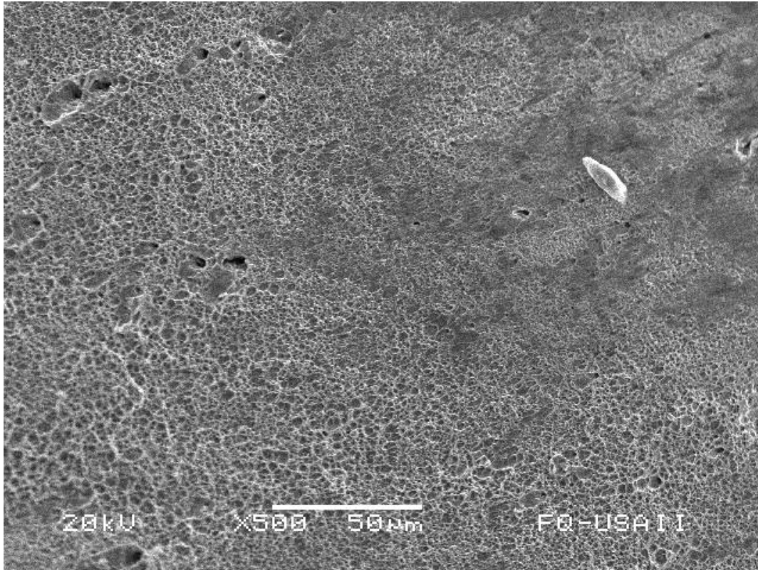
Figura 58. Enfriamiento en mezcla agua – aceite con cargado de hidrógeno.
