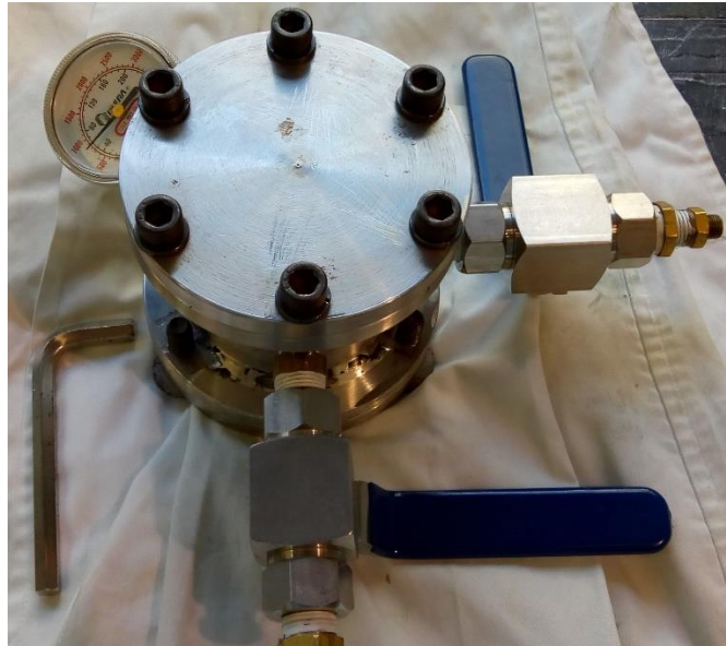
Figura 17. Cámara de doble válvula para cargado de hidrógeno.
