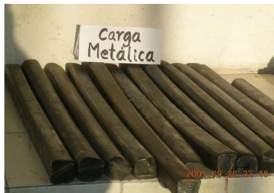
Figura 12. Barras de chatarra de bajo carbono utilizadas para la fabricación del acero microaleado experimental.
