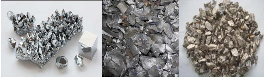
Figura 11. Cargas de elementos microaleantes y ferroaleaciones.
