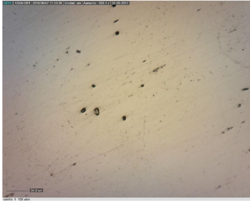
Figura 36. Inclusiones de la probeta enfriada en aire. Aumento 10x. Reactivo Vilella. Microscopio Óptico.
