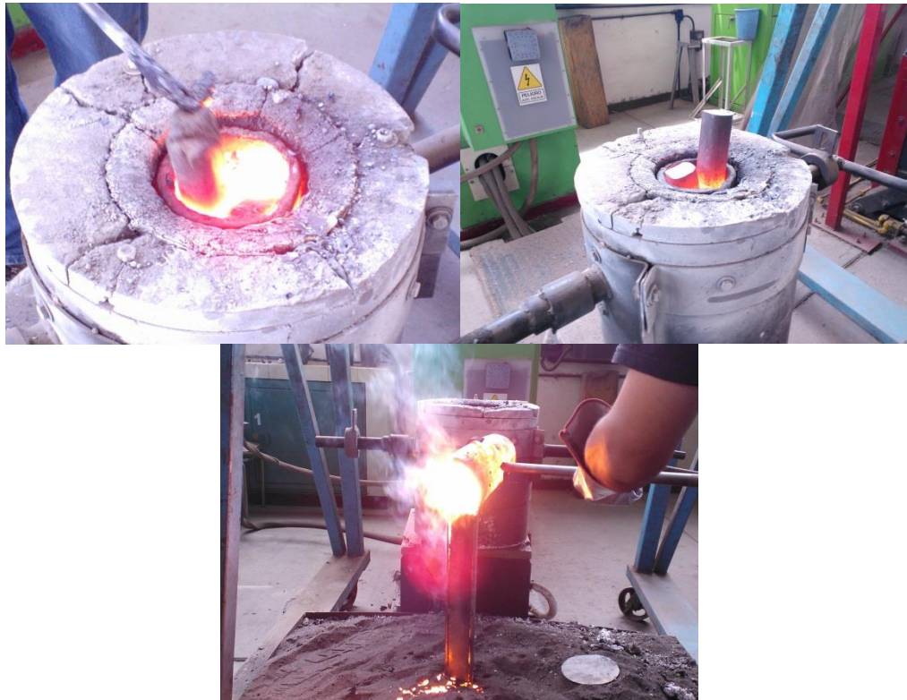
Figura 14. Proceso de fabricación del acero experimental y colada.
